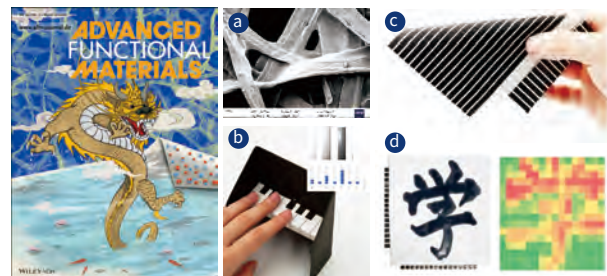
(a) 离子纸电镜图像; (b) 通过折叠形成离子纸压力传感器; (c) 离子纸中所用离子材料; (d) 离子纸工作过程
